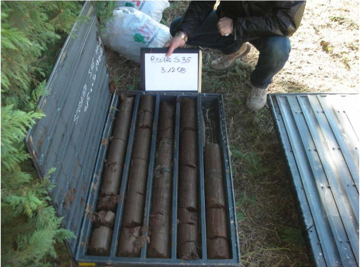
Figura 3: cassetta catalogatrice del sondaggio S35
