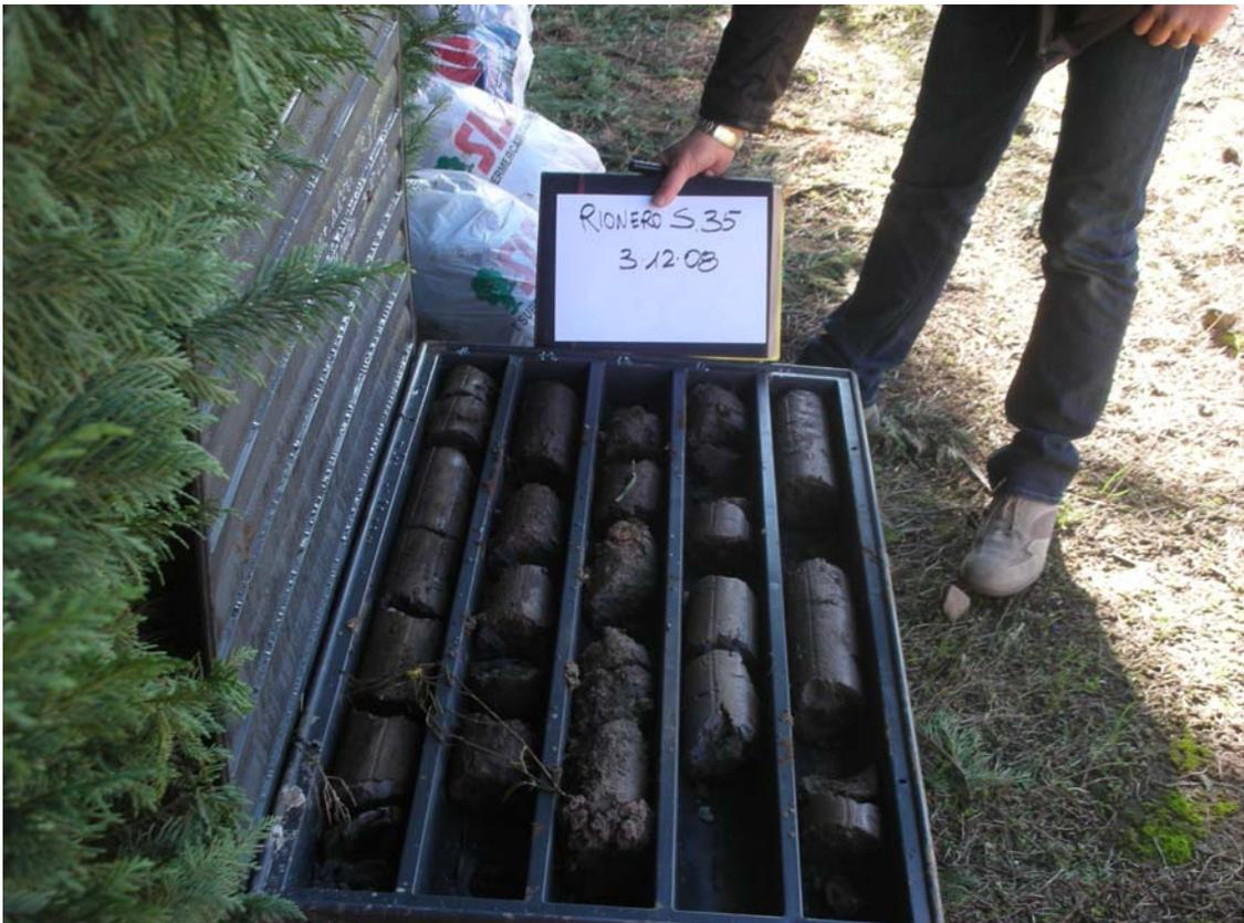
Figura 4: cassetta catalogatrice del sondaggio S35
