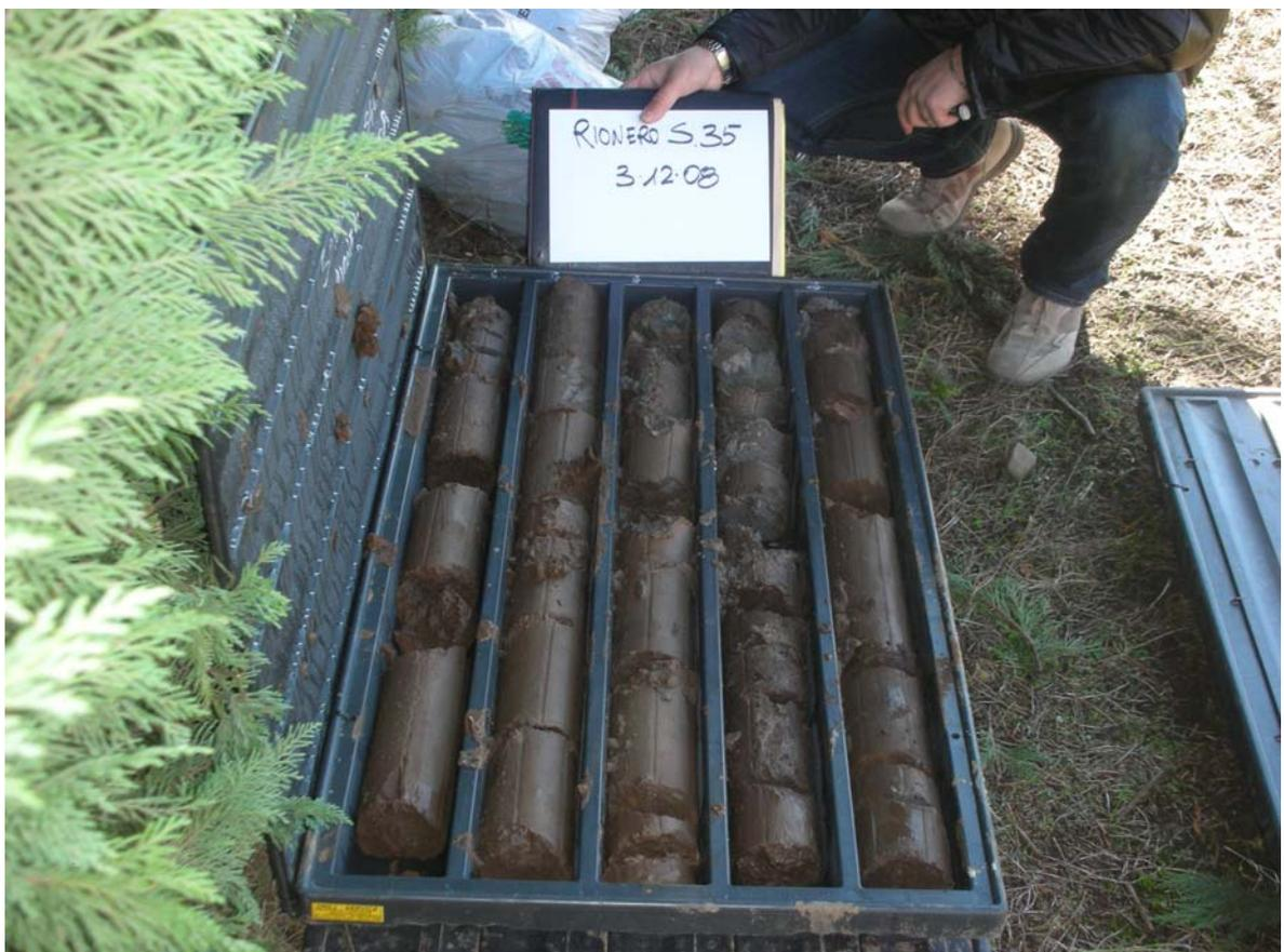
**Figura 2: cassetta catalogatrice del sondaggio S35**
